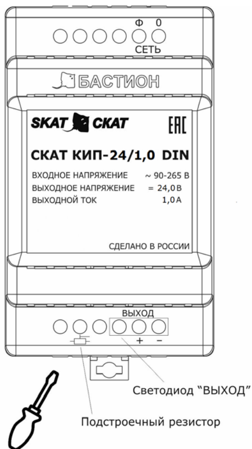
Рисунок 2 – Элементы подключения и индикация
