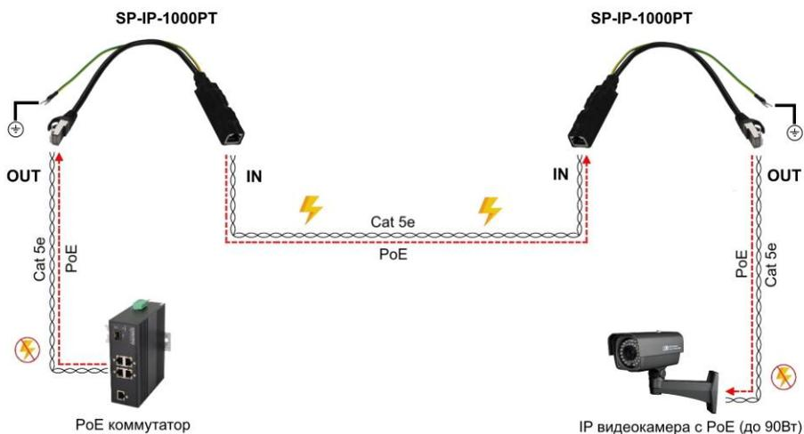
Рис.3 Схема подключения устройств грозозащиты SP-IP-1000PT.
