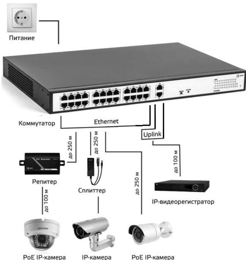
Рисунок 3 – Общая схема подключения устройств к коммутатору
