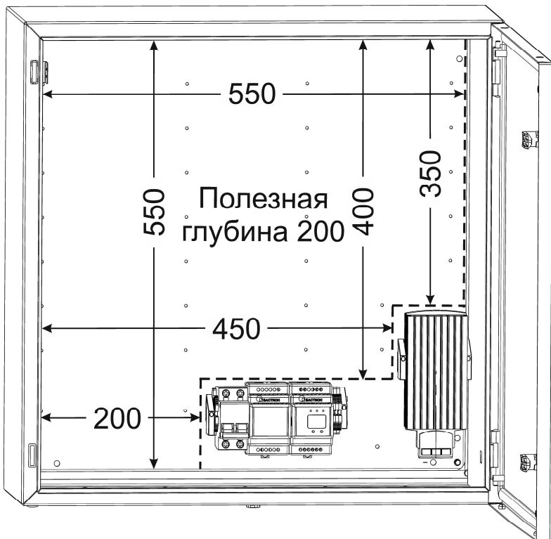
Рисунок 1 – Пространство внутри для установки доп. оборудования
